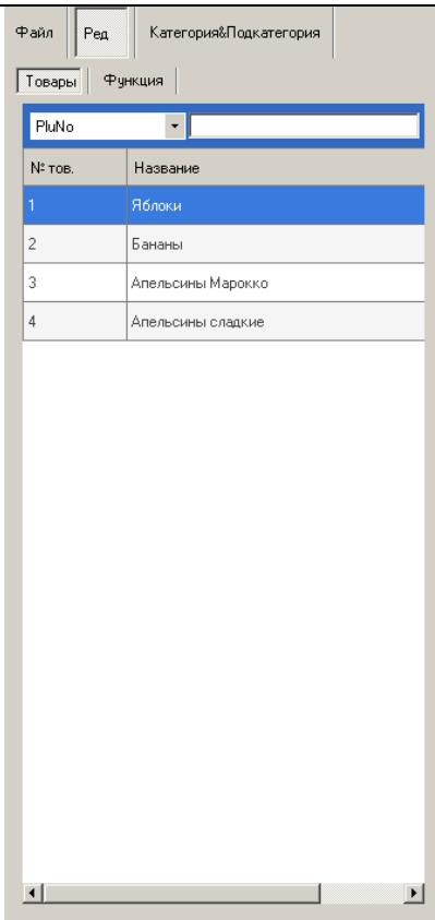
6. Выберите функционал будущей клавиши быстрого вызова товаров: вызов товара или исполнение функции. Для этого нажмите соответствующую вкладку: **Товары** или **Функция**. Описание функций см. в таблице 8.1, а также в руководстве по эксплуатации на весы.
